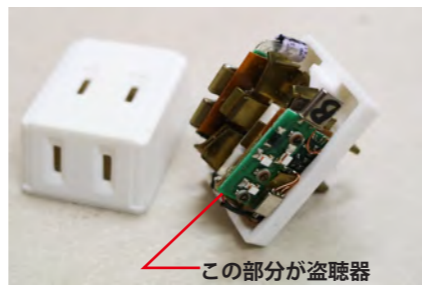
トリプルタップ型盗聴器 コンセントに差し込むだけで、半永久的に盗聴が可能。外観、性能ともに既製品のタップと同じなので、見た目だけでは盗聴器と判別が難しい。
