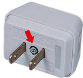
トリプルタップ型盗聴器 コンセントに差し込むだけで、半永久的に盗聴が可能。外観、性能ともに既製品のタップと同じなので、見た目だけでは盗聴器と判別が難しい。
