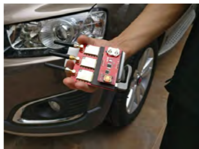
Black Hat USA でデモされた約2,500円で作ったハッキングツール。中国セキュリティ企業「360」のエンジニアは、費用をかけず簡単に車をハッキングできることを警告している。 http://geekcar.com/archives/68050
